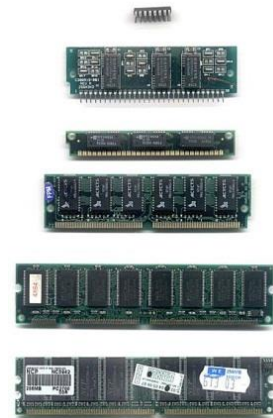
Εικόνα 18 Διάφοροι τύποι μνήμης RAM (σε ανατύπωση από wikipedia.org). Από πάνω προς τα κάτω, DIP, SIPP, SIMM (30-pin), SIMM (72-pin), DIMM (168-pin), DDR DIMM (184-pin).
