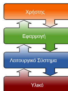
Εικόνα 43 Λειτουργικό Σύστημα, ενδιάμεσος υλικού και λογισμικού
